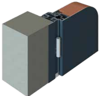
POSE EN BORDS TABLEAU Dormant étroit sans aile + plat de finition
